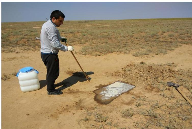
Яма, заполненная водой, для определения влагоемкости почвы
